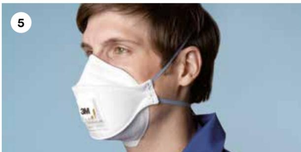
**5.** Ziehen Sie das obere Band auf den Hinterkopf in Position über den Ohren und das untere Band unter die Ohren. Die Bänder dürfen nicht verdreht sein. Positionieren Sie den oberen und unteren Teil des Maskenkörpers so, dass Sie einen bequemen Sitz erhalten. Vergewissern Sie sich, dass die Maskenränder und die Kinnlasche nicht nach innen gefaltet sind.
